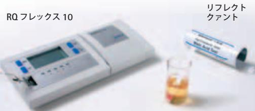
リフレクトクアントシリーズは、比色を目視で行うのではなく、手のひらサイズの反射式光度計 RQ フレックス 10 シリーズ（別売）を用いて行い、ロットごとの検量線データにより試験紙の自動定量が可能となります。こちらもサンプルに浸した試験紙を RQ フレックス 10 シリーズに挟みこむだけの簡単操作で目的物質を迅速に検出します。
