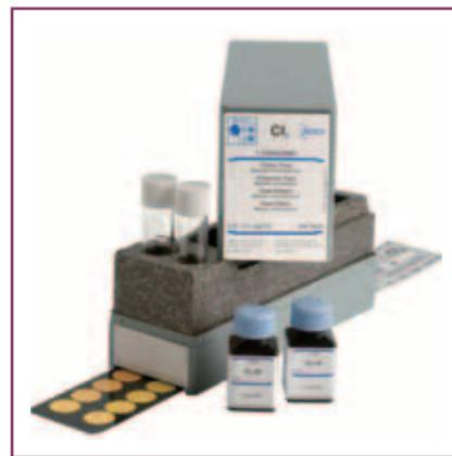
アクアメルク、マイクロクアント、アクアクアントとも、液体サンプルに試薬を添加し発色させてカラースケールと比色する簡易検出キットです。特に低濃度のサンプルを測定される場合は液体比色タイプをご利用ください。
