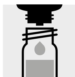
Ajouter 5 gouttes de Ag-5, fermer avec le bouchon fileté et mélanger.
