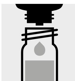
Ajouter 6 gouttes de Au-5, fermer avec le bouchon fileté.
