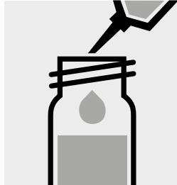
Ajouter 0,25 ml de Cl-1K à la pipette fermer avec le bouchon fileté et mélanger.
