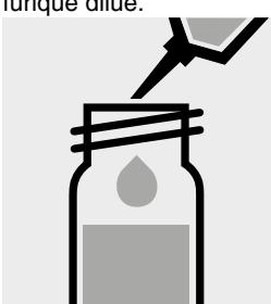
Ajouter 7,0 ml d'eau distillée à la pipette dans le deuxième tube à essai, fermer avec le bouchon fileté et mélanger.
