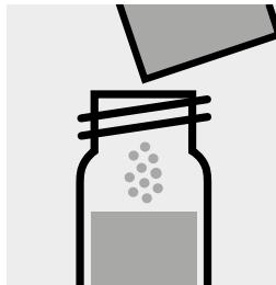
Ajouter 1 sachet de poudre de **Molybdenum HR2**, fermer avec le bouchon fileté et dissoudre la substance solide.
