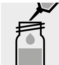
Pipetter 1,0 ml d'échantillon dans un tube à essai et mélanger.
