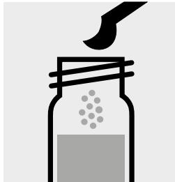
Ajouter 1 microcuvette bleue arasée de CN-3K, fermer avec le bouchon fileté.
