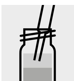
A l'aide d'une pipette Pasteur, aspirer la couche claire supérieure colorée et dessécher sur sulfate de sodium anhydre pour analyses (art. 106649).
