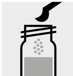
Ajouter 1 microculler verte arasée de Cd-2K, fermer avec le bouchon fileté.
