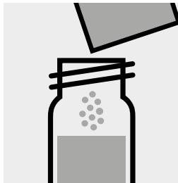
Ajouter 1 sachet de poudre de **Molybdenum HR1**, fermer avec le bouchon fileté et dissoudre la substance solide.
