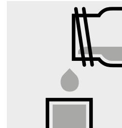
Introduire l'échantillon à mesurer dans la cuve et mesurer **immédiatement**.
