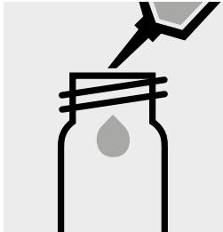
Pipetter 10 ml d'échantillon dans un tube à essai (tubes à fond plat, art. 114902).
