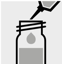
Pipetter 5,0 ml d'échantillon dans un tube à essai, fermer avec le bouchon fileté et mélanger.
