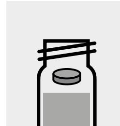
Ajouter 1 **comprimé de réactif Cyanuric Acid**, écraser avec la baguette d'agitation et fermer avec le bouchon fileté.
