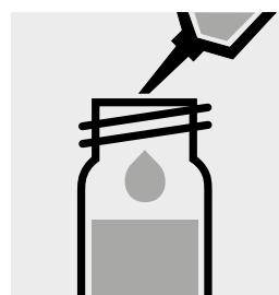
Ajouter 0,20 ml de **Oxyscav 2** à la pipette, fermer avec le bouchon fileté et mélanger.
