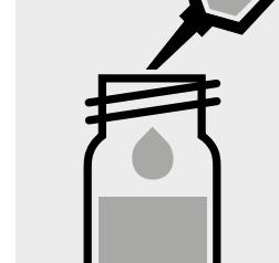
Ajouter 5,0 ml d'**isobutylméthylcétone pour analyses** (art. 106146) à la pipette, fermer avec le bouchon fileté et mélanger.
