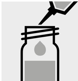
Pipetter 0,50 ml d'échantillon dans un tube à essai, fermer avec le bouchon fileté et mélanger.
