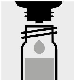
Ajouter 3 gouttes de Cl<sub>2</sub>-2, fermer avec le bouchon fileté et mélanger.
