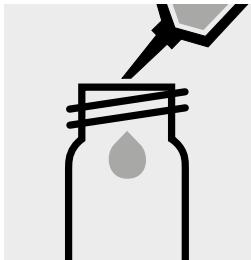
Pipetter 4,5 ml de **HCHO-1** dans un tube vide (tubes vides, art. 114724).
