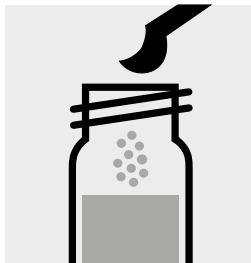
Ajouter 1 microcylinder verte arasée de CN-3, fermer avec le bouchon fileté.
