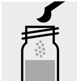
Ajouter 1 microcuiller bleue arasée de Cl<sub>2</sub>-1, fermer avec le bouchon fileté.
