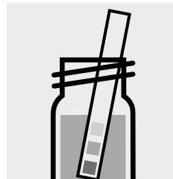
Vérifier le pH de l'échantillon. Résultat nécessaire : pH 6,5
