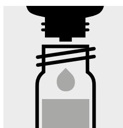
Ajouter 18 gouttes de **B-5**, fermer avec le bouchon fileté et mélanger.
