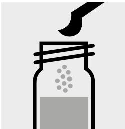
Ajouter 1 microcuiller verte arasée de SO<sub>4</sub>-2, fermer avec le bouchon fileté et mélanger.
