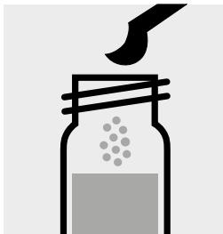
Ajouter 1 microcylinder bleue arasée de CN-4, fermer avec le bouchon fileté.
