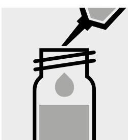
Pipetter 5,0 ml d'échantillon préparé, fermer avec le bouchon fileté et mélanger.
