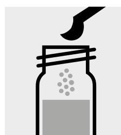
Ajouter 1 microcuiller grise arasée de Zn-5, fermer avec le bouchon fileté et dissoudre la substance solide.
