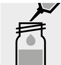
Ajouter 1,0 ml de OA-3K à la pipette, fermer avec le bouchon fileté et mélanger.
