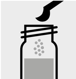
Ajouter 1 microcuvette bleue arasée de Fe-1K, fermer avec le bouchon fileté.
