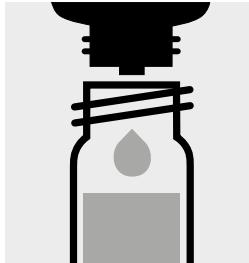
Ajouter 6 gouttes de N-2K, fermer avec le bouchon fileté et mélanger.
