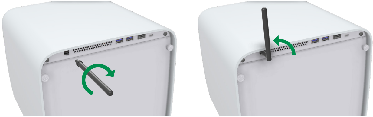
Figura 2.3: Instalación de la antena WiFi
