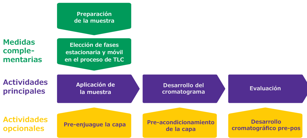
Figura 1.2: Proceso de TLC: preparación de la capa (placa), preparación de la muestra, elección de la fase estacionaria, elección de la fase móvil, aplicación de la muestra, desarrollo, derivatización, documentación
