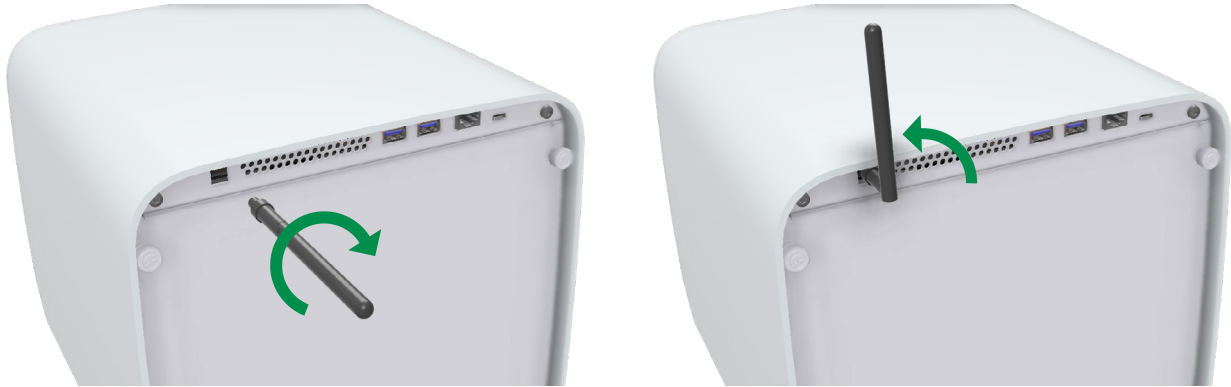
Rajah 2.3: Memasang antena Wi-Fi
