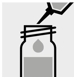
Aggiungere 0,10 ml di **Si-2** con pipetta in ciascuno delle due contenitori, chiudere con tappo a vite e mescolare.
