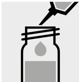
**Lentamente** pipettare 5,0 ml di **campione impoverito** in una cuvetta di reazione. Chiudere bene e mescolare con forza. **Attenzione: la cuvetta diventa calda!**
