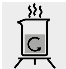
Fare evaporare quasi fino ad essiccazione 250 ml di soluzione campione in un becher collocato sulla piastra di riscaldamento.
