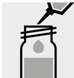
Aggiungere 5,0 ml di **isobutilmetilchetone p.a.** (art. 106146) con pipetta, chiudere la cuvetta con tappo a vite.
