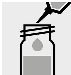
Aggiungere 1,5 ml di campione con pipetta molto lentamente, chiudere la cuvetta con tappo a vite e mescolare **brevemente**. **Attenzione, la cuvetta diventa calda!**
