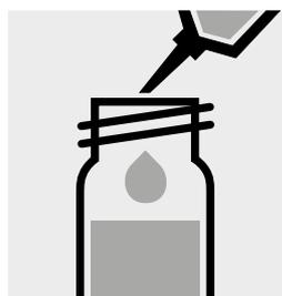
Aggiungere 1,0 ml di **OA-4K** con pipetta, chiudere la cuvette con tappo a vite e mescolare.
