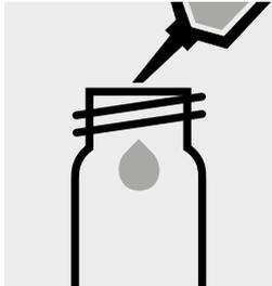
Pipettare 10 ml di campione in una cuvetta rotonda.
