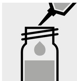
Aggiungere 1,0 ml di **H-1K** con pipetta, chiudere la cuvetta e mescolare.
