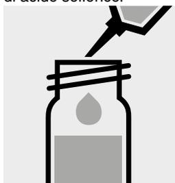
Aggiungere 5,0 ml di **alcol isoamilico p. a.** (art. 100979) con pipetta, chiudere la cuvetta con tappo a vite.
