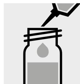
Aggiungere 5,0 ml di **toluene p. a.** (art. 108325) con pipetta, chiudere la cuvetta con tappo a vite.
