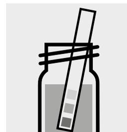
Controllare il pH del campione. Risultato necessario: pH 6,5. Se necessario correggere il pH aggiungendo goccia a goccia una soluzione diluita di idrossido di sodio o di acido solforico.
