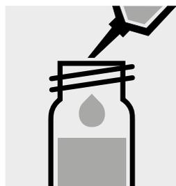
Aggiungere 0,50 ml di **Si-3** con pipetta in ciascuno delle due contenitori, chiudere con tappo a vite e mescolare.
