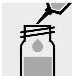
Aggiungere 1,0 ml di **OA-5** con pipetta, chiudere la cuvette con tappo a vite e mescolare.
