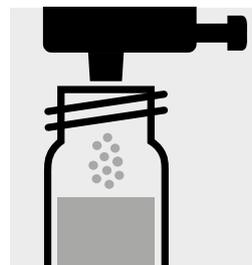
Aggiungere 1 dose di **PO<sub>4</sub>-2K** con il dosatore blu, chiudere la cuvetta con tappo a vite.
