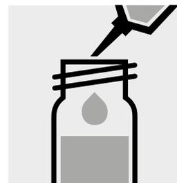
Aggiungere 0,50 ml di **Ca-2K** con pipetta, chiudere la cuvetta con tappo a vite e mescolare.
