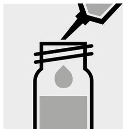
Aggiungere 5,0 ml di **NO<sub>3</sub>-2** con pipetta e chiudere la cuvetta con tappo a vite.
