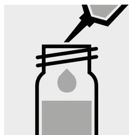
Pipettare 2,5 ml di campione in una provetta con tappo a vite.
