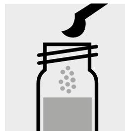
Aggiungere 1 microcucchiaino raso verde di  $\text{SO}_4\text{-1K}$ , chiudere la cuvetta con tappo a vite.
