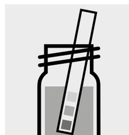
Controllare il pH. Intervallo necessario: pH 4–10. Se necessario correggere il pH aggiungendo goccia a goccia una soluzione diluita di idrossido di sodio o di acido solforico.
