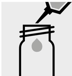
Pipettare 5,0 ml di NO<sub>3</sub>-1 in una cuvetta rotonda vuota ed asciutta (cuvette vuote, art. 114742).
