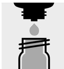
Aggiungere 10 gocce di O<sub>2</sub>-3K, chiudere la cuvetta con tappo a vite, mescolare e pulire la superficie esterna.
