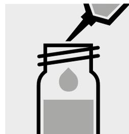
Aggiungere 3,0 ml di campione con pipetta, chiudere la cuvetta e mescolare. **Attenzione, la cuvetta diventa calda!**
