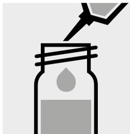
**Lentamente** pipettare 3,0 ml di **campione impoverito** in una cuvetta di reazione. Chiudere bene e mescolare con forza. **Attenzione: la cuvetta diventa calda!**
