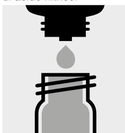
Aggiungere 5 gocce di O<sub>2</sub>-2K, chiudere la cuvetta con tappo a vite ed agitare per 10 secondi.
