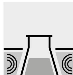
Degassare per 3 minuti in un bagno ad ultrasuoni.
