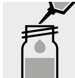
Pipettare 10 ml di acqua distillata in una seconda cuvetta di reazione, chiudere con tappo a vite e mescolare. (Bianco)
