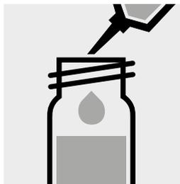
Pipettare 10 ml di campione in una cuvetta di reazione, chiudere con tappo a vite e mescolare.
