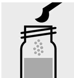
Aggiungere 1 microcucchiaino raso grigio di **Pb-2K** nella cuvetta misurata in precedenza, chiudere la cuvetta con tappo a vite.
