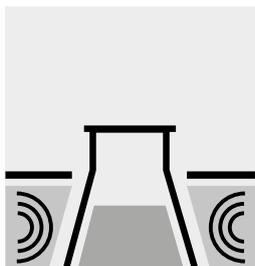
Se il campione contiene aria o gas bolle: degasare in un bagno ad ultrasuoni.
