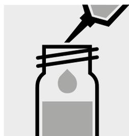
Aggiungere 0,50 ml di **NO<sub>3</sub>-2** con pipetta, chiudere la cuvetta con tappo a vite e mescolare. **Attenzione, la cuvetta diventa calda!**
