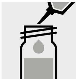
Aggiungere 5,0 ml di **acido solforico al 40 %** con pipetta. Chiudere la cuvetta con tappo a vite e mescolare.
