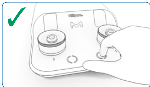
Figura 5: posición CORRECTA del dedo para encender o apagar la bomba
