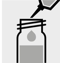
Pipetear 10 ml de la muestra en una cubeta de reacción, cerrar con la tapa roscada y mezclar.
