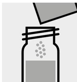
Añadir 1 sobre de polvos de **Molybdenum HR2**, cerrar con la tapa roscada y disolver la sustancia sólida.
