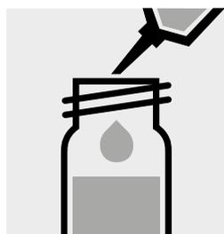
Pipetear 2,0 ml de la muestra en una cubeta de reacción provista de tapa rosca.
