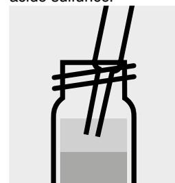
Con una pipeta Pasteur, aspirar la capa clara superior coloreada y secar sobre **sulfato sódico anhidro p. a.** (art. 106649).
