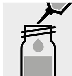
Añadir 5,0 ml de **Zn-6** (art. 106146, isobutilmetilcetona) con la pipeta y cerrar con la tapa roscada el tubo.
