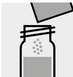
Añadir 1 sobre de polvos de **Molybdenum HR1**, cerrar con la tapa roscada y disolver la sustancia sólida.
