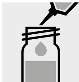
Pipetear 5,0 ml de la muestra en un tubo con tapa roscada.
