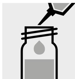
Pipetear 10 ml de la muestra en una cubeta de reacción, cerrar con la tapa roscaada y mezclar.
