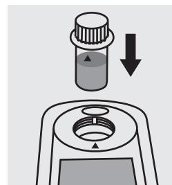
Blindwert-Küvette in den Küvettenschacht einsetzen. Markierung auf der Küvette zu der am Photometer ausrichten.
