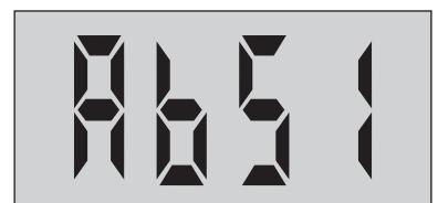
Den Nullabgleich immer mit einer gefüllten (z.B. mit VE-Wasser) Küvette durchführen.
