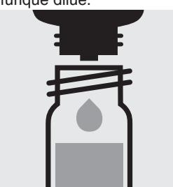
Ajouter 5 gouttes de Zn-3, fermer avec le bouchon fileté et mélanger.
