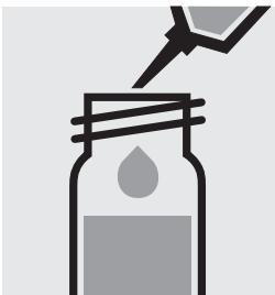
Pipetter 0,100 ml d'eau distillée (nous recommandons l'art. 1.16754, Eau pour analyses EMSURE®) dans un tube avec le bouchon fileté.
