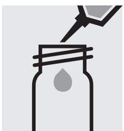
Pipetter 5,0 ml d'échantillon dans un tube.
