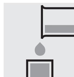
Transvaser l'échantillon de mesure dans la cuve.
