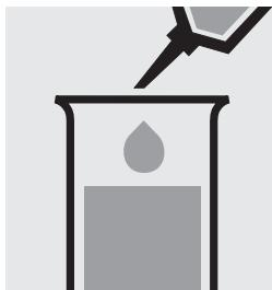
Pipetter 10 ml d'échantillon préparé dans une éprouvette.
