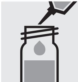
Ajouter 1,0 ml de NO<sub>3</sub>-1K à la pipette, fermer avec le bouchon fileté et mélanger.
