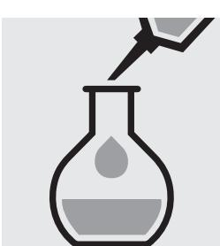
Remplir le ballon gradué jusqu'à la marque avec d'isoctane pour la spectroscopie Uvasol® (art. 1.04718) et mélanger.
