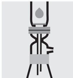
Filtrer la solution ajustée sous vide par un filtre à membrane dans un erlenmeyer propre et sec.
