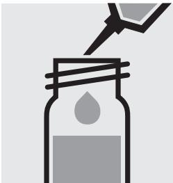
Pipetter **prudemment** 2,0 ml d'échantillon dans un tube à essai, fermer hermétiquement avec le bouchon fileté et mélanger vigoureusement. **Attention, le tube devient brûlant.**
