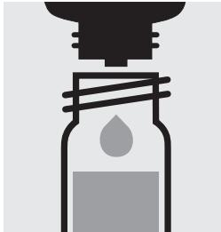
Verser 6 gouttes de Sn-1K dans un tube à essai, fermer avec le bouchon fileté et mélanger.
