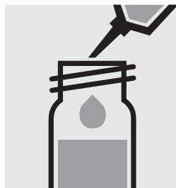
Ajouter 7,0 ml d'échantillon à la pipette dans un tube à essai, fermer avec le bouchon fileté et mélanger.
