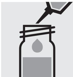
Pipetter 2,0 ml d'échantillon dans le tube à essai, **ne pas mélanger**.
