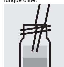
A l'aide d'une pipette Pasteur, aspirer la couche claire supérieure colorée et dessécher sur **sulfate de sodium anhydre pour analyses** (art. 1.06649).
