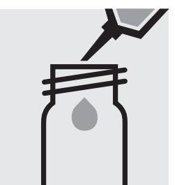
Pipetter 5,0 ml d'échantillon dans un tube.
