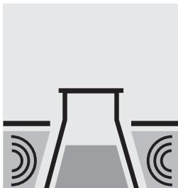
Si l'échantillon contient l'air ou des bulles de gaz : dégazer dans un bain à ultrasons.
