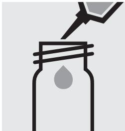
Pipetter 5,0 ml de l'échantillon dilué à 1 :4 dans un tube vide (tubes vides, art. 1.14724).
