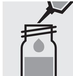
Ajouter 0,50 ml de T-1K à la pipette et fermer avec le bouchon fileté.
