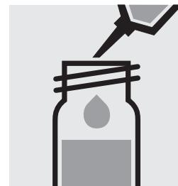
Ajouter 0,50 ml de **réactif 2** à la pipette. Fermer avec le bouchon fileté et mélanger.
