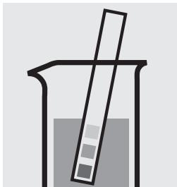
Vérifier le pH de l'échantillon. Domaine nécessaire : pH 4 – 10
