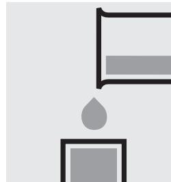
Transvaser l'**échantillon de mesure** dans la cuve.
