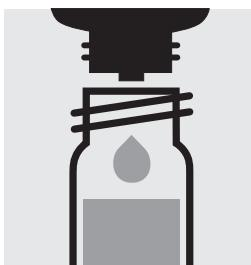
Ajouter 1 goutte de Ag-4, fermer avec le bouchon fileté et mélanger.
