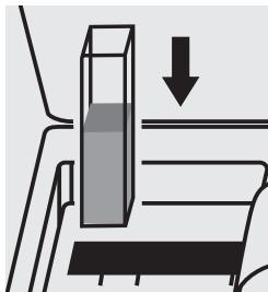
Placer la cuve dans le compartiment. La mesure de la valeur à blanc est effectuée automatiquement.
