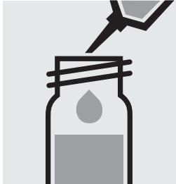
Pipetter 0,50 ml de **Cl-1K** dans un tube essai, fermer avec le bouchon fileté et mélanger.
