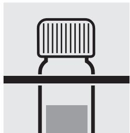
Retirer le tube du thermoréacteur, le laisser refroidir dans un support d'éprouvettes.
