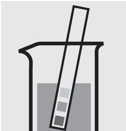
Vérifier le pH de l'échantillon. Domaine nécessaire : pH 2 – 7
