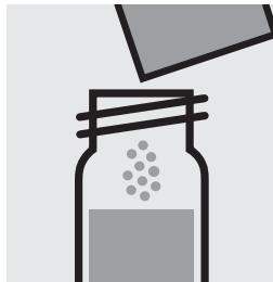
Ajouter 1 sachet de poudre de **Molybdenum HR3** et fermer avec le bouchon fileté.
