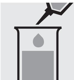
Pipetter 1,0 ml d'eau distillée (nous recommandons l'art. 1.16754, Eau pour analyses EMSURE®) dans un récipient en plastique.
