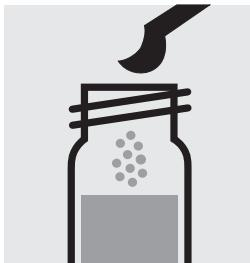
Verser 1 microcuiller arasée de **NO<sub>3</sub>-1K** dans un tube à essai, fermer avec le bouchon fileté.
