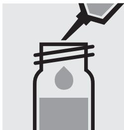
Ajouter 1,0 ml d'**acide phosphorique 85 % pour analyses** (art. 1.00573) à la pipette. Fermer avec le bouchon fileté et mélanger.
