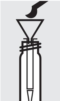
Mettre la colonne dans un tube vide, placer l'entonnoir en verre, verser 1 microcuiller bleue arasée de **AOX-1**.
