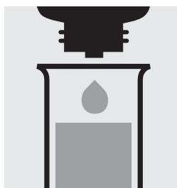
Ajouter 4 gouttes de **NH<sub>4</sub>-3** (provenant du test Ammonium Spectroquant®, art 1.14752) et mélanger.
