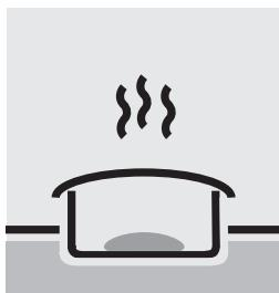
Peser l'échantillon avec une exactitude de 1 mg dans un récipient approprié et effectuer une incinération conformément à l'article 64 de LFGB 06.00-4 [3].
