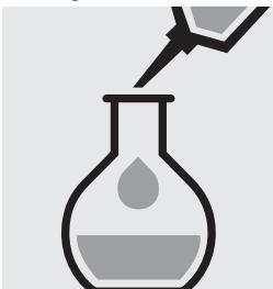
Compléter le ballon jaugé avec **d'acide sulfurique 0,05 mol/l** et bien mélanger : **solution 1**.
