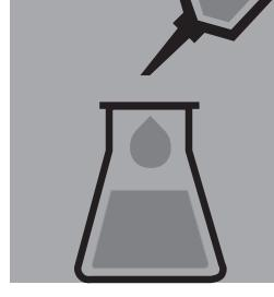
Aciduler une partie de l'extrait avec de l'**acide chlorhydrique 1 mol/l Titripur®** (art. 1.09057) (50 µl par 5 ml d'extrait).
