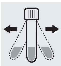
Agiter vigoureusement le tube pour dissoudre la substance solide et laisser reposer 1 minute.
