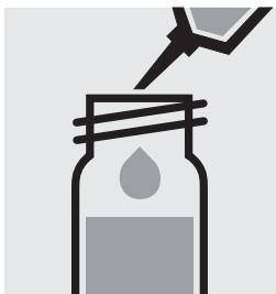
Ajouter 0,10 ml de **Si-2** à la pipette dans chacun de deux récipients, fermer avec le bouchon fileté et mélanger.
