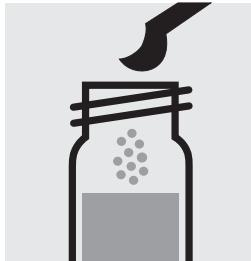
Ajouter 1 microcuvette bleue arasée de CN-1K, fermer avec le bouchon fileté.
