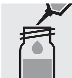
A l'aide de la pipette en verre, prélever dans le tube de minéralisation (exempt de charbon) 7,0 ml d'**échantillon préparé** et pipetter dans le tube à essai, fermer avec le bouchon fileté et mélanger.
