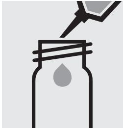
Pipetter 5,0 ml d'échantillon dans un tube à essai, fermer avec le bouchon fileté et dissoudre la substance solide.
