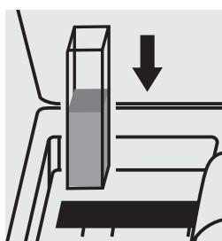
Placer la **cuvette B** dans le compartiment. La mesure est effectuée automatiquement.
