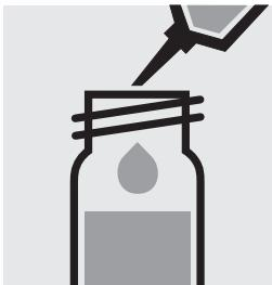
Ajouter 0,50 ml d'échantillon à la pipette, fermer avec le bouchon fileté et mélanger.
