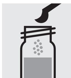
Ajouter 2 microcuillers vertes arsées **AOX-6**, fermer le tube avec le bouchon fileté et mélanger.
