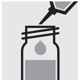
Ajouter 1,0 ml de **B-1** à la pipette, fermer avec le bouchon fileté et mélanger.
