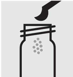
Verser 1 microcuiller arasée de **NO<sub>3</sub>-1** dans un tube vide (tubes vides, art. 1.14724) et sèche.
