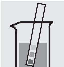
Vérifier le pH de l'échantillon. Domaine nécessaire : pH 3 – 9
