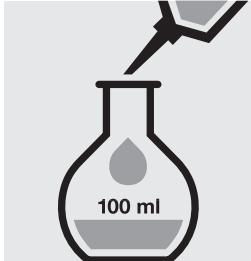
Pipetter 5,0 ml d'échantillon dans un ballon jaugé de 100 ml, remplir d'eau distillée jusqu'au trait et bien mélanger.
