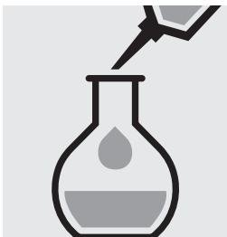
Remplir le ballon gradué jusqu'à la marque avec de l'eau distillée (nous recommandons l'art. 1.16754, Eau pour analyses EMSURE®) et mélanger.
