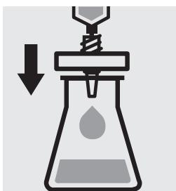
Filtrer la solution à doser sur une membrane filtrante taille de pores 0,45 µm.
