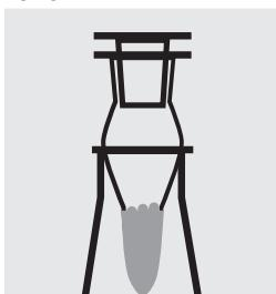
Fermer les tubes absorbeurs de bouchons de verre et les placer sur les erlenmeyers.
