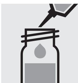
Ajouter 5,0 ml de **toluol pour analyses** (art. 1.08325) à la pipette. Fermer avec le bouchon fileté.
