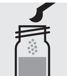
Ajouter 1 microcuvette bleue arasée de Cl<sub>2</sub>-1, fermer avec le bouchon fileté.
