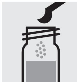
Ajouter 1 microculler grise arasée de SO<sub>3</sub>-1K dans chacun de deux tubes à essai, fermer avec le bouchon fileté.
