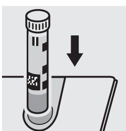
Placer le tube de l'échantillon dans le compartiment, faire coïncider le trait du tube sur celui du photomètre.
