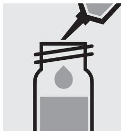
Ajouter 2,0 ml de **réactif DNSA** à la pipette, fermer et mélanger.
