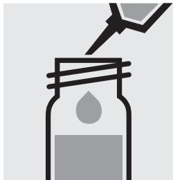
Pipetter 5,0 ml d'échantillon dans un tube avec le bouchon fileté.
