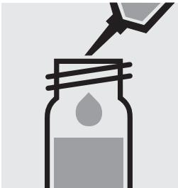
Pipetter 5,0 ml d'échantillon dans un tube à essai, fermer avec le bouchon fileté et mélanger.
