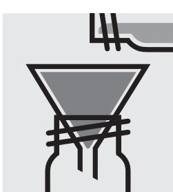
Filtrer à travers un filtre rond dans un tube à col à vis avec le bouchon fileté.
