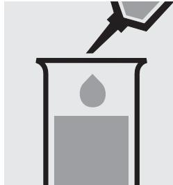
Ajouter 2,0 ml de **solution réactionnelle de Biuret** à la pipette et mélanger.
