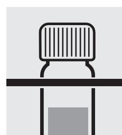
Retirer le tube de thermoréacteur, le laisser refroidir jusqu'à température ambiante dans un support d'éprouvettes.
