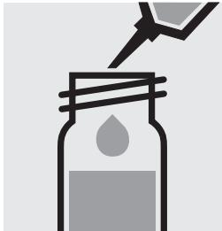
Pipetter 7,0 ml d'échantillon dans un tube à essai, fermer avec le bouchon fileté et mélanger.
