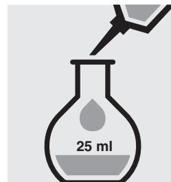
Compléter le ballon jaugé avec de l'eau distillée jusqu'au trait de jauge (nous recommandons l'art. 1.16754, Eau pour analyses EMSURE®), bien mélanger et filtrer si nécessaire : échantillon préparé.
