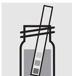
Vérifier le pH de l'échantillon. Domaine nécessaire : pH 4 – 10 Si nécessaire, ajuster le pH en ajoutant goutte à goutte du sodium hydroxyde en solution diluée ou de l'acide sulfurique dilué.
