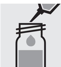
Ajouter 0,20 ml de Cl-2 à la pipette dans chacune des deux éprouvettes et mélanger.
