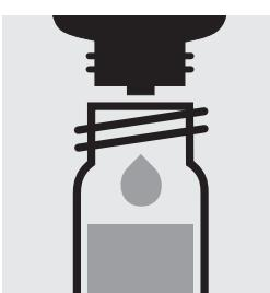
Ajouter 3 gouttes de Zn-4, fermer avec le bouchon fileté et mélanger.
