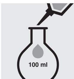
Pipetter un volume approprié de la solution d'échantillon préparée avec une exactitude de 0,1 ml dans un ballon jaugé de 100 ml.
