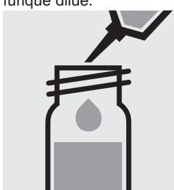
Ajouter 5,0 ml d'**alcool isoamyllique pour analyses** (art. 1.00979) à la pipette. Fermer avec le bouchon fileté.
