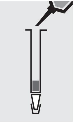
Boucher le bas de la colonne. Verser 1 ml de **AOX-3**. Boucher le haut de la colonne et agiter afin d'éliminer les bulles d'air. Déboucher le haut de la colonne et remplir à ras bord de **AOX-3**.
