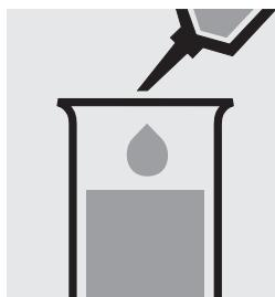
Ajouter 2,0 ml de **solution réactionnelle de Biuret** à la pipette et mélanger.
