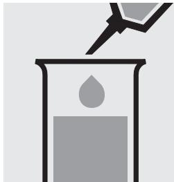
Pipetter 5,0 ml d'eau distillée (nous recommandons l'art. 1.16754, Eau pour analyses EMSURE®) dans une deuxième éprouvette. (Blanc)
