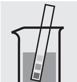
Vérifier le pH de l'échantillon. Domaine nécessaire : pH 2 – 11
