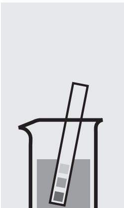
Vérifier le pH de l'échantillon. Domaine nécessaire : pH 6 – 7. Si nécessaire, ajuster le pH en ajoutant goutte à goutte du sodium hydroxyde en solution diluée ou de l'acide nitrique dilué.
