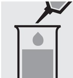
Pipetter 5,0 ml de NH<sub>4</sub>-1 dans une éprouvette.
