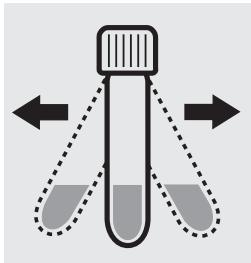
**Agiter vigoureusement** le tube pendant **1 minute** pour dis-soudre la substance solide.
