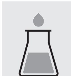
Ajuster la valeur pH de la solution préparée avec de l'hydroxyde de sodium en solution 0,1 mol/l (art. 1.09141) ou de l'acide chlorhydrique 0,1 mol/l (art. 1.09060) à pH 7,0 ± 0,1.
