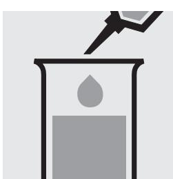
Pipetter 5,0 ml d'échantillon dans une éprouvette.
