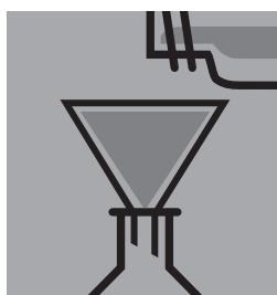
En opérant à l'abri de la lumière, filtrer l'extrait par un filtre en papier (« Blauband ») dans un ballon jaugé (selon DIN 38412 : 100 ml). Rincer le filtre avec un peu d'éthanol.
