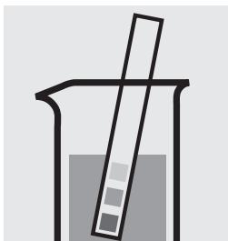
Vérifier le pH de l'échantillon. Domaine nécessaire : pH 4 – 9
