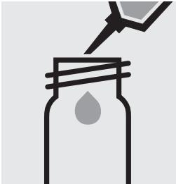
Pipetter 1,0 ml de **B-1K** dans un tube à essai, fermer avec le bouchon fileté et mélanger.
