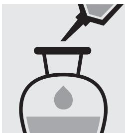
Pipetter 10 ml de chloroforme, boucher l'entonnoir à décantation.
