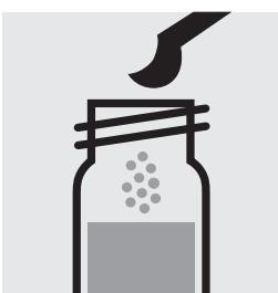
Ajouter 1 microcuiller grise arasée de Pb-2K dans le tube déjà analysé, fermer avec le bouchon fileté.
