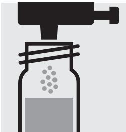
Ajouter 1 dose de PO<sub>4</sub>-2K avec le capuchon doseur bleu, fermer avec le bouchon fileté.
