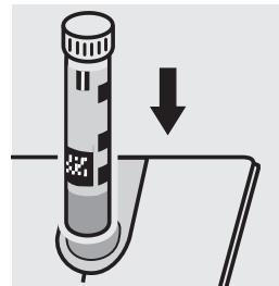
Placer le tube à blanc dans le compartiment, faire coïncider le trait du tube sur celui du photomètre.
