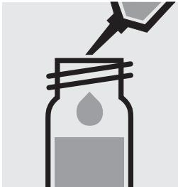
Ajouter 1,5 ml d'échantillon à la pipette lentement, fermer avec le bouchon fileté et mélanger **brièvement**. Attention, le tube devient brûlant.
