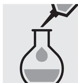
Compléter le ballon jaugé avec de l'eau distillée jusqu'au trait de jauge (nous recommandons l'art. 1.16754, Eau pour analyses EMSURE®) et bien mélanger.
