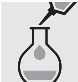
Ajouter 0,25 ml de réactif 1 à la pipette.
