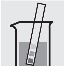
Vérifier le pH de l'échantillon. Domaine nécessaire : pH 2,5 – 7,5 Si nécessaire, ajuster le pH en ajoutant goutte à goutte du sodium hydroxyde en solution diluée ou de l'acide nitrique dilué.
