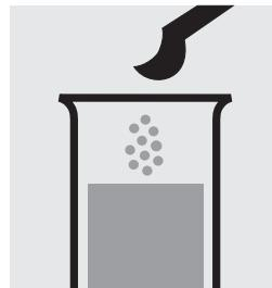
Ajouter 1 microcuvette bleue arasée de **NH<sub>4</sub>-2** (provenant du test Ammonium Spectroquant®, art 1.14752).
