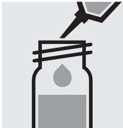
Pipetter 10 ml d'échantillon dans un tube à essai, fermer avec le bouchon fileté et mélanger.
