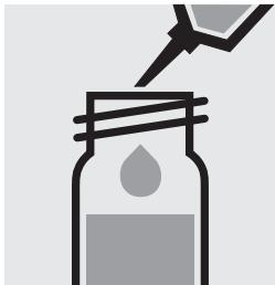
Pipetter **prudemment** 3,0 ml d'**échantillon appauvri** dans un tube à essai, fermer hermétiquement avec le bouchon fileté et mélanger vigoureusement. **Attention, le tube devient brûlant.**
