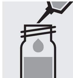
Ajouter 0,10 ml de **Si-1** à la pipette dans chacun de deux récipients, fermer avec le bouchon fileté et mélanger.
