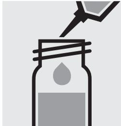
Ajouter 5,0 ml d'eau distillée (nous recommandons l'art. 1.16754, Eau pour analyses EMSURE®) à la pipette, fermer avec le bouchon fileté et mélanger.
