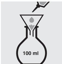
Rincer l'échantillon avec environ 80 ml d'eau distillée (nous recommandons l'art. 1.16754, Eau pour analyses EMSURE®) dans un ballon gradué de 100 ml.
