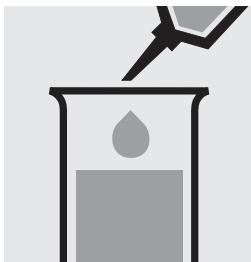
Pipetter 5,0 ml d'échantillon dans une éprouvette.
