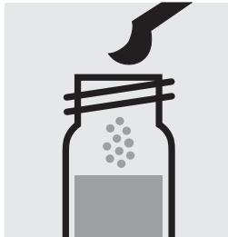
Ajouter 1 microcuvette bleu arasée de NO<sub>3</sub>-1, fermer immédiatement avec le bouchon fileté.
