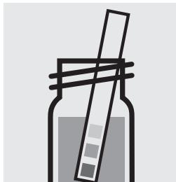
Vérifier le pH de l'échantillon. Résultat nécessaire : pH 3,0
