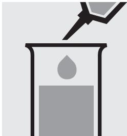
Pipetter 0,05 ml d'échantillon dans un récipient en plastique.
