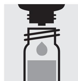
Ajouter 5 gouttes **AOX-4**, boucher avec le bouchon fileté et mélanger. Faire décanter le charbon actif. solution surnageante : échantillon préparé
