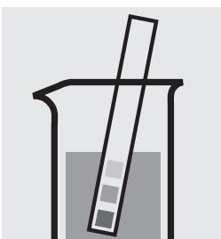
Vérifier le pH de l'échantillon. Domaine nécessaire : pH 4 – 13
