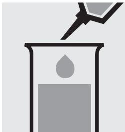
Pipetter 1,0 ml d'échantillon dans une éprouvette.
