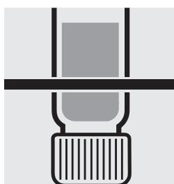
Retirer le tube du thermoreacteur, le laisser refroidir **placé la tête en bas** 1 heure.
