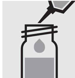
Ajouter 0,5 ml de Co-1K à la pipette, fermer avec le bouchon fileté et mélanger.
