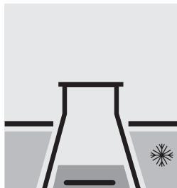
Ajouter dans chacun une baguette d'agitation magnétique et refroidir dans un bain de glace.
