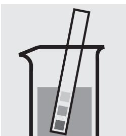
Vérifier le pH de l'échantillon. Domaine nécessaire : pH 4 – 8
