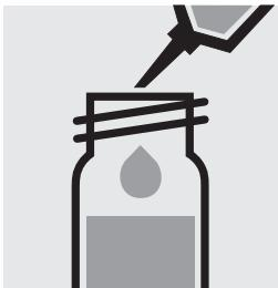
Ajouter 0,20 ml de **réactif 2** à la pipette, fermer avec le bouchon fileté et mélanger.
