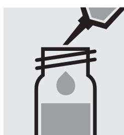
Ajouter 5,0 ml de Zn-6 (art. 1.06146, isobutylméthylcétone) à la pipette et fermer avec le bouchon fileté.
