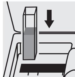
Placer la **cuve A** dans le compartiment. La mesure est effectuée automatiquement.
