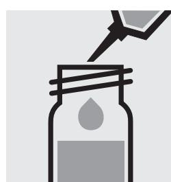
Ajouter 5,0 ml d'**isobutylméthylcétone pour analyses** (art. 1.06146) à la pipette, fermer avec le bouchon fileté et mélanger.
