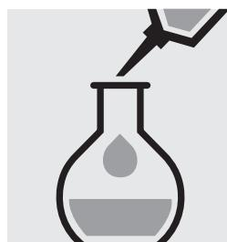
Compléter le ballon jaugé avec de l'eau distillée jusqu'au trait de jauge (nous recommandons l'art. 1.16754, Eau pour analyses EMSURE®) et bien mélanger : **solution d'échantillon préparée**.
