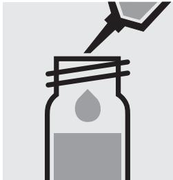
Pipetter 6,0 ml d'échantillon dans un tube à essai, fermer avec le bouchon fileté et mélanger.
