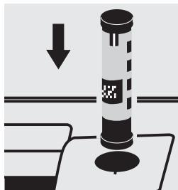
Sélectionner la méthode 2,0 – 75,0 mg/l de NH<sub>4</sub>-N avec l'AutoSelector.
