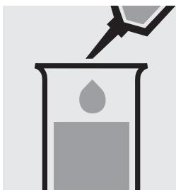
Pipetter 10 ml d'échantillon dans une éprouvette.
