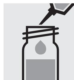
Ajouter 2,0 ml d'**acide chlorhydrique 6 mol/l** à la pipette, fermer et mélanger.
