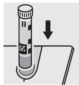
Placer le **tube PO<sub>4</sub>-P** dans le compartiment, faire coïncider le trait du tube sur celui du photomètre.
