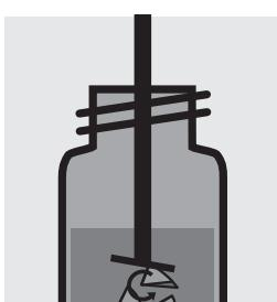
Broyer le filtre à l'aide d'un homogénéisateur
