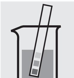
Vérifier le pH de l'échantillon. Valeur nécessaire : pH 7,0. Si nécessaire, ajuster le pH en ajoutant goutte à goutte du sodium hydroxyde en solution diluée ou de l'acide sulfurique dilué.
