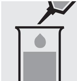
Pipetter 10 ml d'échantillon dans une éprouvette.
