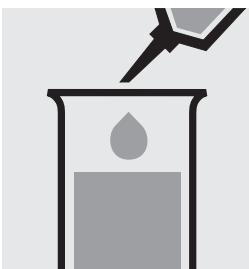
Pipetter 0,5 ml d'échantillon dans un récipient en plastique.
