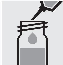
Ajouter à la pipette 0,50 ml de Ca-2K, fermer avec le bouchon fileté et mélanger.
