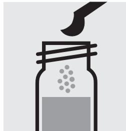
Ajouter 1 microcuiller bleue arasée de F-1K, dans chacun de deux tubes, fermer avec le bouchon fileté.
