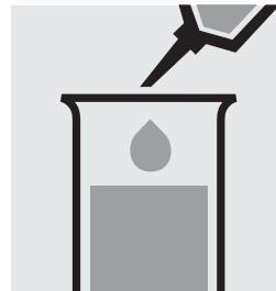
Ajouter 0,60 ml de **NH<sub>4</sub>-1** (provenant du test Ammonium Spectroquant®, art 1.14752) à la pipette et mélanger.
