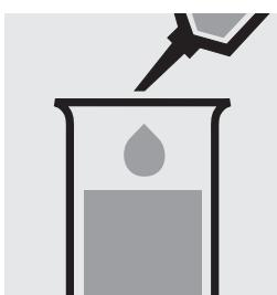
Pipetter 0,50 ml d'échantillon dans une éprouvette.
