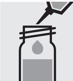
Ajouter 5 ml de **réactif d'oxydation** et mélanger.
