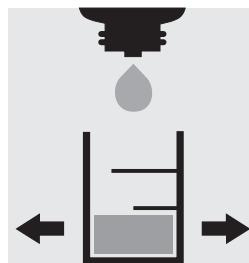
Vérifier la teneur de chlorure de l'échantillon appauvri à l'aide du test chlorures MQuant® (art. 1.11132) conformément aux consignes d'application (cf. site web) : Consigne <2000 mg/l de Cl<sup>-</sup>
