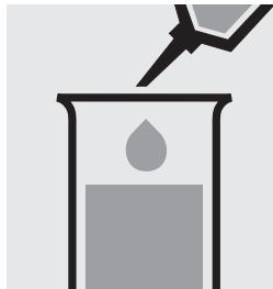
Pipetter 0,50 ml de SO<sub>4</sub>-1 dans une éprouvette.
