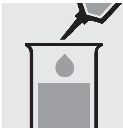
Ajouter 1,5 ml de réactif 2 à la pipette et mélanger.
