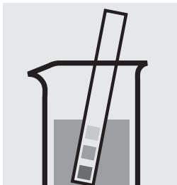
Vérifier le pH de l'échantillon. Domaine nécessaire : pH 1 – 9
