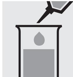
Ajouter 10 ml d'eau distillée (nous recommandons l'art. 1.16754, Eau pour analyses EMSURE®) à la pipette dans la deuxième éprouvette et mélanger.
