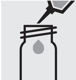
Pipetter 5,0 ml d'échantillon dans un tube à essai vide (p. ex. tubes à fond plat, art. 1.14902).
