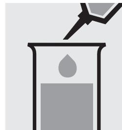
Ajouter 0,20 ml de réactif 2 à la pipette et mélanger.
