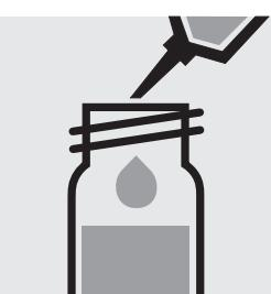
Pipetter 1,0 ml d'échantillon préparé dans un tube avec le bouchon fileté.
