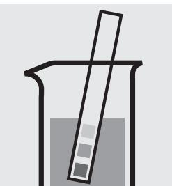
Vérifier le pH de l'échantillon. Domaine nécessaire : pH 4 – 13. Si nécessaire, ajuster le pH en ajoutant goutte à goutte du sodium hydroxyde en solution diluée ou de l'acide sulfurique dilué.
