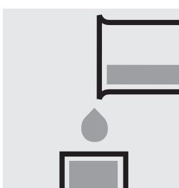
Transvaser la solution de tube d'absorption dans la cuve souhaitée.
