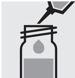
Pipetter 2,0 ml d'échantillon dans un tube avec le bouchon fileté.
