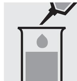
Ajouter 2,5 ml de **solution réactionnelle de Bradford** à la pipette et mélanger.
