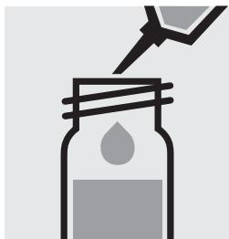
Ajouter **immédiatement** 1,5 ml de NO<sub>3</sub>-2 à la pipette, fermer avec le bouchon fileté.
