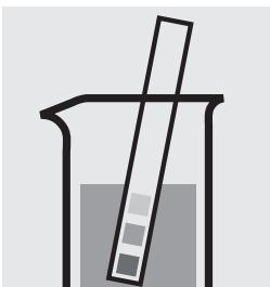
Vérifier le pH de l'échantillon. Domaine nécessaire : pH 1 – 9 Si nécessaire, ajuster le pH en ajoutant goutte à goutte du sodium hydroxyde en solution diluée ou de l'acide sulfurique dilué.
