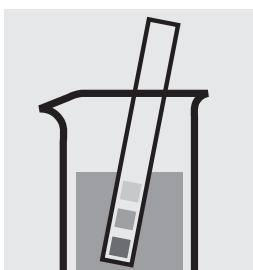
Vérifier le pH de l'échantillon. Domaine nécessaire : pH 5 – 10
