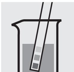
Vérifier le pH de l'échantillon. Domaine nécessaire : pH 0 – 10
