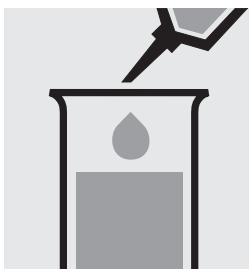
Pipetter 0,25 ml d'échantillon dans un récipient en plastique.
