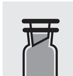
Incuber à 20 ± 1 °C pendant 5 jours dans une armoire thermostatique hermétiquement bouchés 1 flacon d'**échantillon préparé** et 1 de **solution de sels nutritifs inoculée**.
