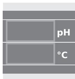
Sélectionner la méthode n° **2520**. Saisir le pH et la température en °C de l'échantillon original.
