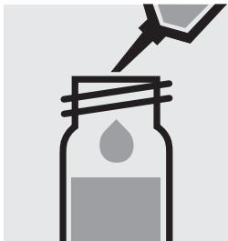
Pipetter 1,0 ml de NO<sub>3</sub>-1K dans un tube à essai, **ne pas mélanger**.
