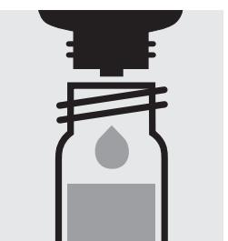
Ajouter 2 gouttes de Cl<sub>2</sub>-2 fermer avec le bouchon fileté et mélanger.
