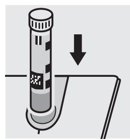
Effectuer la détermination de **phosphore total** (cf. méthode d'analyse « Dosage de phosphore total » avec 1.14729). = **tube Σ P**
