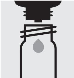
Verser 6 gouttes de Cr-3K dans un tube à essai, fermer avec le bouchon fileté.
