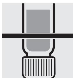
Retirer le tube du thermoréacteur, le laisser refroidir **placé la tête en bas** 1 heure.
