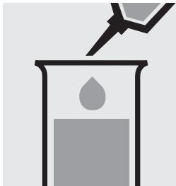
Pipetter 5,0 ml d'échantillon dans une éprouvette.
