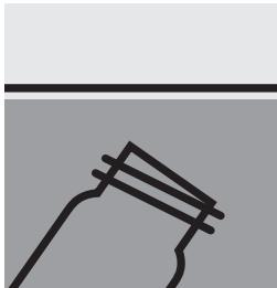
Remplir entièrement sans bulles d'air (1) un tube à essai avec de l'eau à doser.
