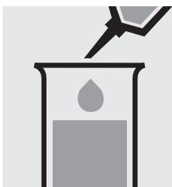
Ajouter 2,5 ml de **solution réactionnelle de Bradford** à la pipette et mélanger.
