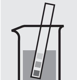
Vérifier le pH de l'échantillon. Domaine nécessaire : pH 3 – 11
