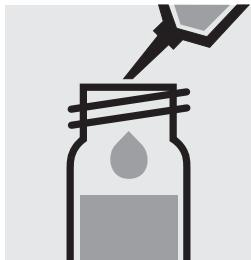
Ajouter 1,0 ml de **réactif 1** à la pipette, fermer avec le bouchon fileté et mélanger.
