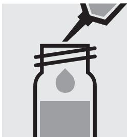
Ajouter 8,0 ml de **solution d'hydroxyde de sodium 2,5 mol/l** à la pipette et mélanger.
