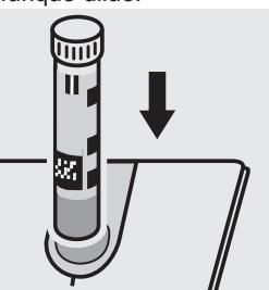
Placer le tube dans le compartiment, faire coïncider le trait du tube sur celui du photomètre.
