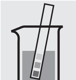
Vérifier le pH de l'échantillon. Domaine nécessaire : pH 2 – 10
