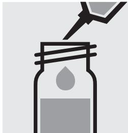
Ajouter 3,0 ml d'échantillon à la pipette, fermer avec le bouchon fileté et mélanger.
