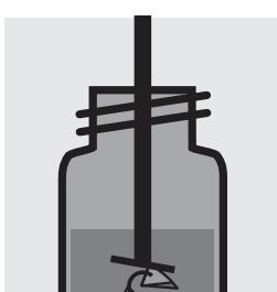
Broyer le filtre à l'aide d'un homogénéisateur
