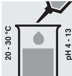
Pipetter 5,0 ml d'échantillon dans une éprouvette. Si nécessaire, ajuster le pH en ajoutant goutte à goutte du sodium hydroxyde en solution diluée ou de l'acide sulfurique dilué, et amener l'échantillon à la température requise
