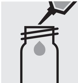
Pipetter 10 ml d'échantillon dans un récipient en plastique (**Tubes à fond plat, art. 1.17988**).
