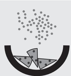
Mélanger avec le sable marin et effectuer une extraction conformément à l'article 64 de LFGB 03.00.37, chapitre 9.1.1 [1] : **extrait d'échantillon.**
