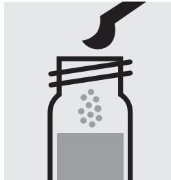
Ajouter 1 microcuiller verte arasée de SO<sub>4</sub>-1K, fermer avec le bouchon fileté.
