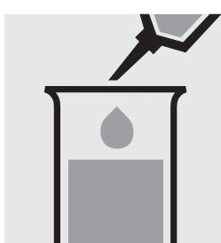
Ajouter 0,20 ml de réactif 2 à la pipette et mélanger.
