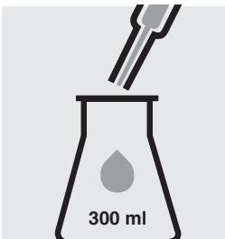
Donner un échantillon de 20 ml dans un erlenmeyer de 300 ml à joint 29/32 à l'aide d'une pipette de verre.
