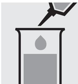
Pipetter 10 ml d'échantillon dans une éprouvette.
