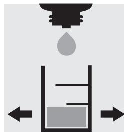
Vérifier la teneur de chlorure de l'échantillon appauvri à l'aide du test chlorures MQuant® (art. 1.11132) conformément aux consignes d'application (cf. site web) : Consigne <250 mg/l de Cl<sup>-</sup>
