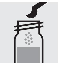
Ajouter 1 microcuvette bleue arasée de Cl<sub>2</sub>-1, fermer avec le bouchon fileté.
