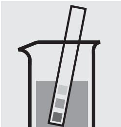
Vérifier le pH de l'échantillon. Domaine nécessaire : pH 1,5 – 2,2
