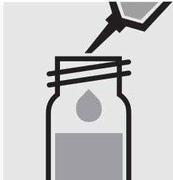
Ajouter 4,0 ml d'échantillon à la pipette, fermer le tube avec le bouchon fileté.
