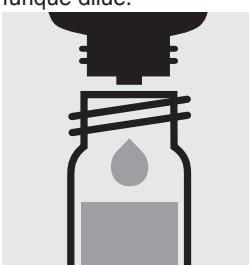
Ajouter 2 gouttes de Cl<sub>2</sub>-3, fermer avec le bouchon fileté et mélanger.
