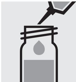
Pipetter 2,0 ml d'échantillon préparé dans un vaisseau (20 ml) qui peut être fermé.
