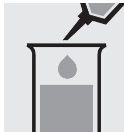
Ajouter 0,10 ml de réactif 1 à la pipette et mélanger.
