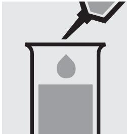
Pipetter 5,0 ml d'échantillon dans une éprouvette.
