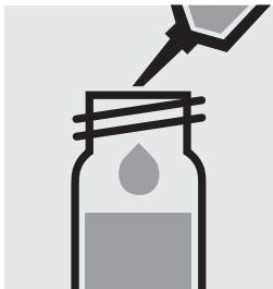
Pipetter 0,50 ml d'échantillon dans un tube à essai, **ne pas mélanger**.
