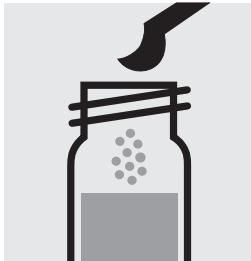
Verser 1 microcuiller verte arasée de **HCHO-1K** dans un tube à essai, fermer avec le bouchon fileté.
