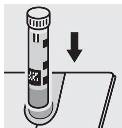
Placer le tube à blanc dans le compartiment, faire coïncider le trait du tube sur celui du photomètre.
