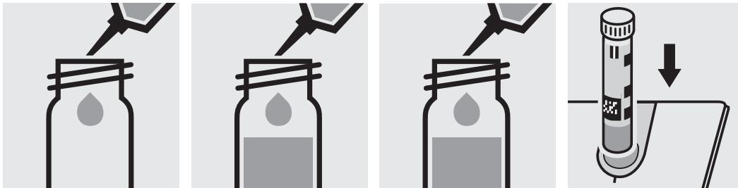
Pipetter 4,0 ml de **AC-1** dans un tube.
