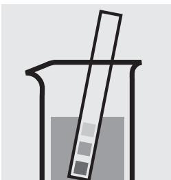
Vérifier le pH de l'échantillon. Domaine nécessaire : pH 2 – 5
