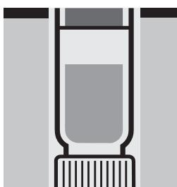
Chauder le tube placé la tête en bas 2 heures à 120 °C dans le thermoreacteur.
