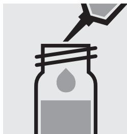
Ajouter 1,5 ml d'échantillon préparé à la pipette lentement, fermer avec le bouchon fileté et mélanger brièvement.
