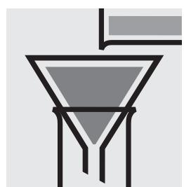
Filtrer tout le mélange à travers un filtre hydrophobe conformément à EN 1141 [1] ou l'article 64 de LFGB 31.00-7 [2] : **blanc réactif**.
