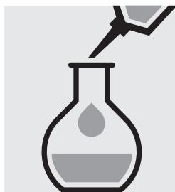
Compléter le ballon jaugé avec de l'eau distillée jusqu'au trait de jauge (nous recommandons l'art. 1.16754, Eau pour analyses EMSURE®) et bien mélanger.
