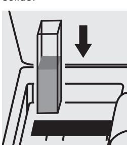
Placer la cuve de l'échantillon dans le compartiment.
