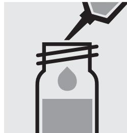
Pipetter **prudemment** 5,0 ml d'**échantillon à blanc appauvri** dans un deuxième tube à essai, fermer hermétiquement avec le bouchon fileté et mélanger vigoureusement. **Attention, le tube devient brûlant.**
