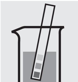
Vérifier le pH de l'échantillon. Domaine nécessaire : pH 1 – 12. Si nécessaire, ajuster le pH en ajoutant goutte à goutte de la solution ammoniacale diluée ou de l'acide nitrique dilué.
