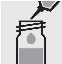
Pipetter 0,20 ml d'échantillon dans un tube à essai, fermer avec le bouchon fileté et mélanger.
