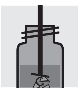
Broyer le filtre à l'aide d'un homogénéisateur
