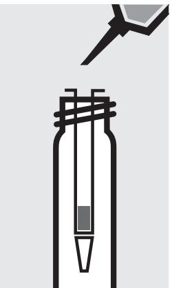
Séparer la colonne du réservoir, Faire couler à 3 reprises 1 ml à chaque fois de réactif **AOX-3** au travers de la colonne. Jeter la solution de lavage.
