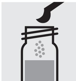
Verser 1 microcuiller verte arasée de **HCHO-2**, fermer avec le bouchon fileté.
