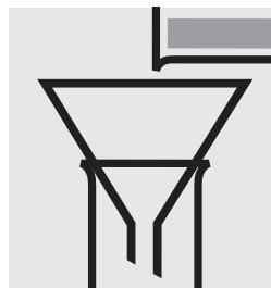
Transvaser le résidu avec un peu d'eau distillée (nous recommandons l'art. 1.16754, Eau pour analyses EMSURE®) dans un ballon jaugé de 25 ml.
