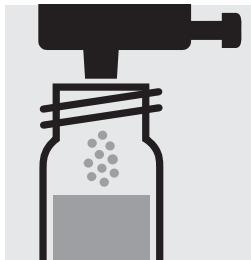
Ajouter 1 dose de NH<sub>4</sub>-1K avec le capuchon doseur bleu, fermer avec le bouchon fileté.
