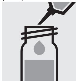
Ajouter 0,50 ml de **Si-3** à la pipette dans chacun de deux récipients, fermer avec le bouchon fileté et mélanger.
