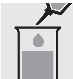
Pipetter 0,25 ml d'eau distillée (nous recommandons l'art. 1.16754, Eau pour analyses EMSURE®) ou solution tampon dans un récipient en plastique.
