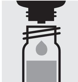
Ajouter 5 gouttes de Cu-1K, fermer avec le bouchon fileté et mélanger.
