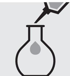
Si nécessaire, diluer l'échantillon avec de l'eau distillée jusqu'au trait de jauge (nous recommandons l'art. 1.16754, Eau pour analyses EMSURE®).
