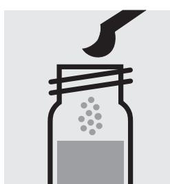
Ajouter 1 microculler grise arasée de Zn-5, fermer avec le bouchon fileté et dissoudre la substance solide.
