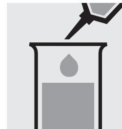
Ajouter 0,20 ml de d'acide perchlorique 70 - 72 % pour analyses (art. 1.00519) à la pipette et mélanger.
