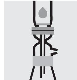
Filtrer la **solution préparée** sous vide par un filtre à membrane dans un erlenmeyer propre et sec.
