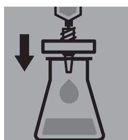
En opérant à **l'abri de la lumière**, filtrer l'extrait par un filtre adéquatec un peu d'éthanol.
