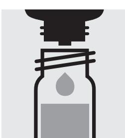
Mélanger le filtrat avec 4 gouttes de SO<sub>4</sub>-4 et fermer avec le bouchon fileté.
