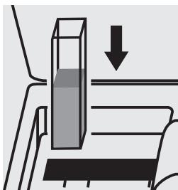
Placer la cuve de l'échantillon dans le compartiment.
