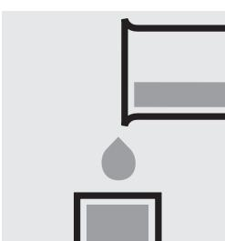
Transvaser l'échantillon de mesure dans la cuve.
