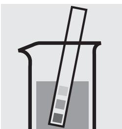
Vérifier le pH de l'échantillon. Domaine nécessaire : pH 4 – 10. Si nécessaire, ajuster le pH en ajoutant goutte à goutte du sodium hydroxyde en solution diluée ou de l'acide chlorhydrique dilué.
