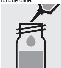
Ajouter 7,0 ml d'eau distillée à la pipette dans le deuxième tube à essai, fermer avec le bouchon fileté et mélanger. (blanc)
