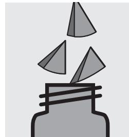
Introduire les fragments de filtre dans un flacon d'extraction (p. ex. un flacon de verre brun de 100 ml).
