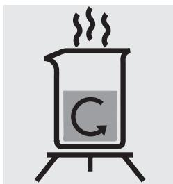
Evaporer presque jusqu'à dessiccation dans un bêcher sur une plaque chauffante 250 ml de solution à analyser.
