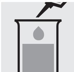
Pipetter 5,0 ml d'échantillon dans une éprouvette.
