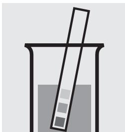
Vérifier le pH. Domaine nécessaire : pH 2,0 – 2,5. Si nécessaire, ajuster le pH en ajoutant goutte à goutte du sodium hydroxyde en solution ou de l'acide sulfurique dilués.
