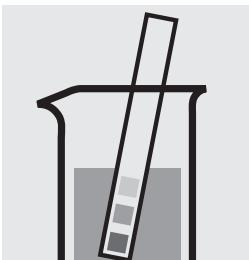
Vérifier le pH de l'échantillon. Domaine nécessaire : pH 4 – 13
