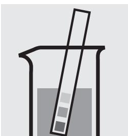
Vérifier le pH de l'échantillon. Domaine nécessaire : pH 3 – 6
