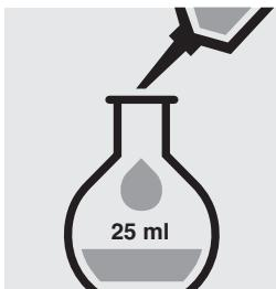
Pipetter 4,0 ml d'échantillon dans un ballon jaugé de 25 ml.
