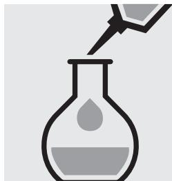
Ajouter 20 ml de **réactif de molybdate de sodium/de l'acide ascorbique** et mélanger.
