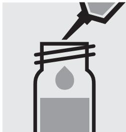
Pipetter 5,0 ml d'eau distillée (nous recommandons l'art. 1.16754, Eau pour analyses EMSURE®) dans un deuxième tube à essai, fermer avec le bouchon fileté et mélanger.
