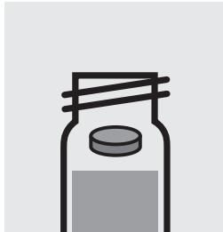
Ajouter 1 **comprimé de réactif Cyanuric Acid**, écraser avec la baguette d'agitation et fermer avec le bouchon fileté et mélanger.
