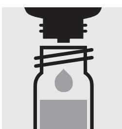
Ajouter 3 gouttes de **CN-2**, fermer avec la bouchon fileté et mélanger : **échantillon préparé**.
