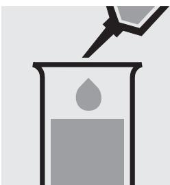
Pipetter 0,05 ml d'eau distillée (nous recommandons l'art. 1.16754, Eau pour analyses EMSURE®) ou solution tampon dans un récipient en plastique.
