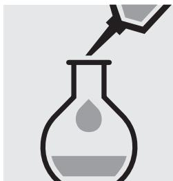
Ajouter 1,0 ml de réactif 3 à la pipette et remplir d'eau distillée jusqu'au trait et bien mélanger.
