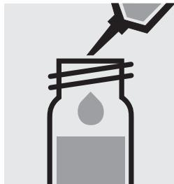
Ajouter 10 ml d'échantillon à la pipette, fermer avec le bouchon fileté.
