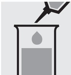
Pipetter 5,0 ml d'échantillon dans une éprouvette.
