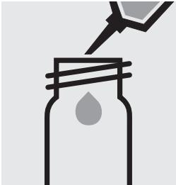
Ajouter 9,0 ml d'eau distillée (nous recommandons l'art. 1.16754, Eau pour analyses EMSURE®) à la pipette.
