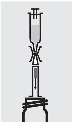
Mettre l'embout à la partie inférieure de la colonne. A l'aide d'une seringue plastique, rincer le charbon de la colonne avec 10 ml de **AOX-5** dans un tube vide.
