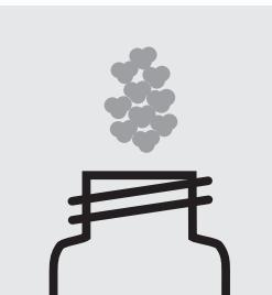
Peser env. 2 g d'échantillon avec une exactitude de 1 mg dans un flacon de laboratoire DURAN® et le traiter conformément à l'article 64 de LFGB 06.00-8, chapitre 7.1 [1].
