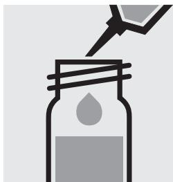
Ajouter 1,0 ml de N-3K à la pipette, fermer avec le bouchon fileté et mélanger. **Attention, le tube devient brûlant.**
