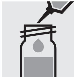
Ajouter 1,0 ml de Ca-1K à la pipette, fermer avec le bouchon fileté et mélanger.
