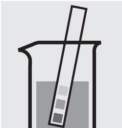
Vérifier le pH de l'échantillon. Domaine nécessaire : pH <3
