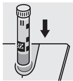
Placer le **tube PO<sub>4</sub>-P** dans le compartiment, faire coïncider le trait du tube sur celui du photomètre.
