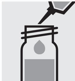
Ajouter 2,0 ml d'**acide chlorhydrique 6 mol/l** à la pipette, fermer et mélanger.
