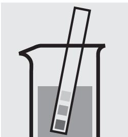
Vérifier le pH de l'échantillon. Domaine nécessaire : pH 2 – 10 Si nécessaire, ajuster le pH en ajoutant goutte à goutte du sodium hydroxyde en solution diluée ou de l'acide sulfurique dilué.
