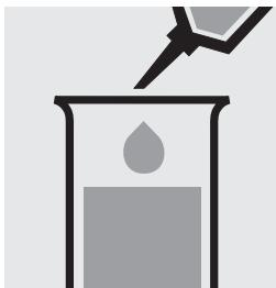
Pipetter 5,0 ml d'échantillon dans une éprouvette.
