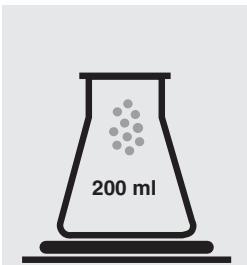
Peser 10 g d'échantillon préparé avec une exactitude de 1 mg dans un erlenmeyer et effectuer une extraction conformément à EN ISO 11052 [1] ou l'article 64 de LFGB 16.01-3 [2] : échantillon de mesure.
