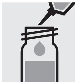
Ajouter 2,0 ml de **solution de ninhydrine**, fermer avec le bouchon fileté et mélanger.
