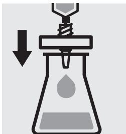
Filtrer la solution à doser sur une membrane filtrante taille de pores 0,45 µm.
