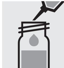
Ajouter 1,5 ml d'échantillon à la pipette lentement, fermer avec le bouchon fileté et mélanger **brièvement**.
