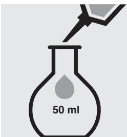
Introduire 1 ml d'échantillon préparée dans un ballon jaugé de 50 ml.
