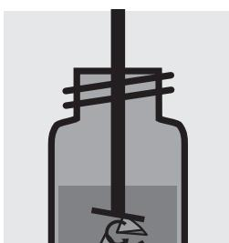
Broyer le filtre à l'aide d'un homogénéisateur. Rincer avec un peu d'éthanol.
