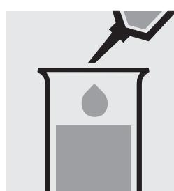
Ajouter 0,20 ml de d'acide perchlorique 70 - 72 % pour analyses (art. 1.00519) à la pipette et mélanger.
