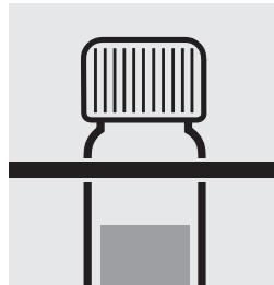
Retirer le tube du thermoréacteur, le laisser refroidir dans un support d'éprouvettes jusqu'à température ambiante.
