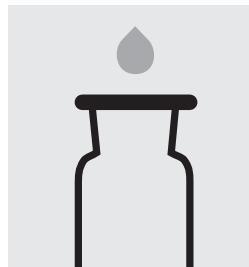
Remplir jusqu'au trop-plein 2 flacons à réaction de l'oxygène avec **la solution de sels nutritifs inoculée** et 2 perles de verre. Boucher sans bulles d'air avec le bouchon en verre biseauté.
