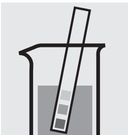
Vérifier le pH de l'échantillon. Domaine nécessaire : pH 4,5 – 8,0
