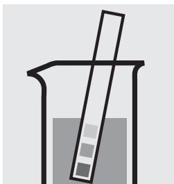
Vérifier le pH de l'échantillon. Domaine nécessaire : pH 0 – 13
