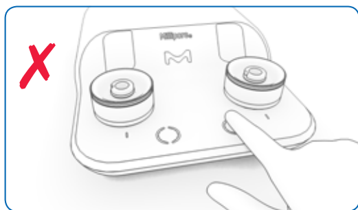
Figura 4: ERRORE – nessuna attivazione se il dito tocca l'anello esterno
