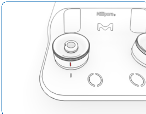
Figura 11: la testa della pompa è nella posizione corretta quando la sua tacca è allineata con quella sulla pompa
