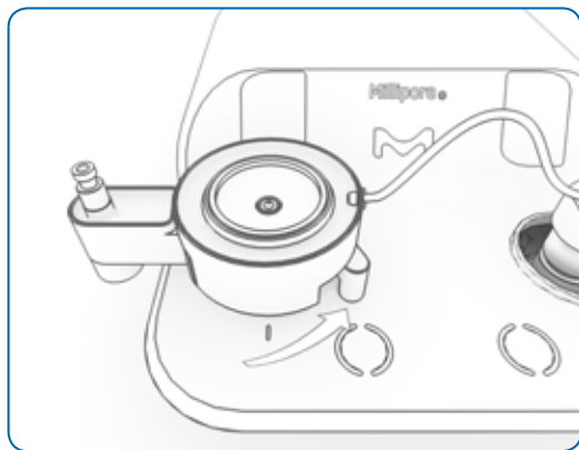
Figura 20: levetta ruotata in senso antiorario
