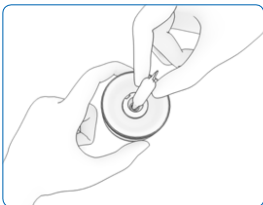
Figura 27: installazione della valvola di ritegno con l'apposito attrezzo – 2
