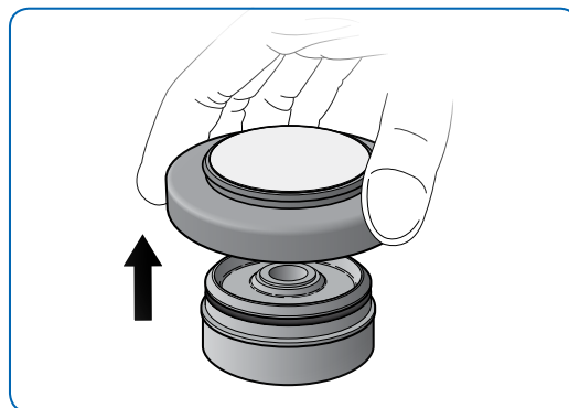
Figura 18: rimozione della base dell'unità filtrante
