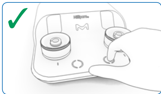
Figura 5: posizione del dito CORRETTA per l'accensione o lo spegnimento della pompa
