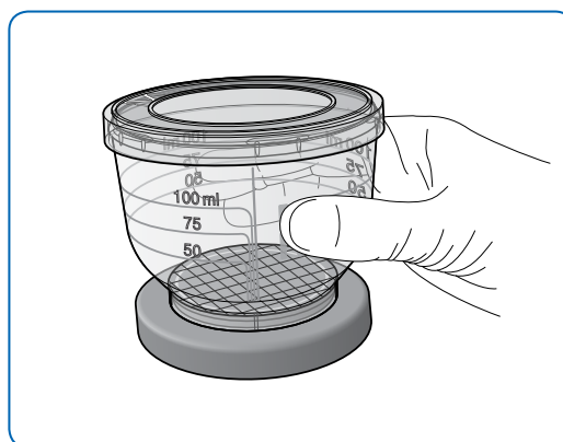
Figura 12: rimozione dell'unità filtrante dalla confezione
