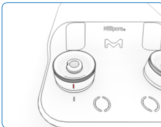
Figura 33: la testa della pompa è nella posizione corretta quando la sua tacca è allineata con quella sulla pompa
