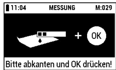
Überschüssige Flüssigkeit sorgfältig über die Längskante des Stäbchens auf ein saugfähiges Papiertuch ablaufen lassen und Taste [OK] drücken.
