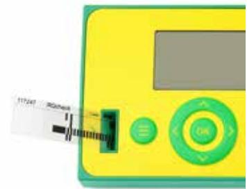
Das Teststäbchen für RQcheck in den Stäbchenadapter einlegen und Taste [START Messung] drücken.
