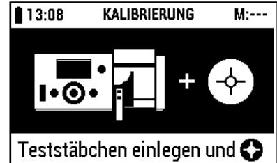
Das Teststäbchen für die Kalibrierung aus dem Rekalibrations-Set (im Lieferumfang des RQflex® 20 enthalten) mit der abgeschrägten Kante nach außen und nach oben in den Stäbchenadapter einlegen und Taste [START Messung] drücken.
