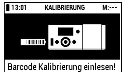
Barcode-Streifen für die Kalibration aus der Verpackung entnehmen (im Lieferumfang des RQflex® 20 enthalten).
