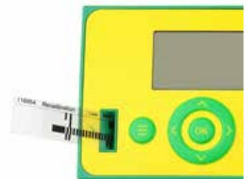
Wenn sichergestellt ist, dass sich kein Teststäbchen im Stäbchenadapter befindet, Taste [OK] drücken.
