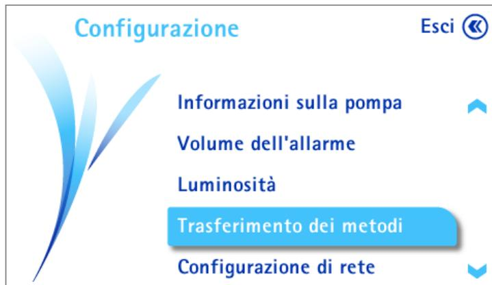
5. Ruotare e premere la manopola di regolazione per selezionare **Trasferimento dei metodi**. Si apre la schermata del menu **Trasferimento dei metodi**.
