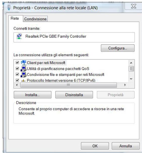
4. Selezionare la linguetta Rete tab e scegliere Protocollo Internet Versione 4 (TCP/IPv4). Cliccare su Proprietà. Viene visualizzata la finestra Proprietà – Protocollo Internet Versione (TCP/IPv4).
