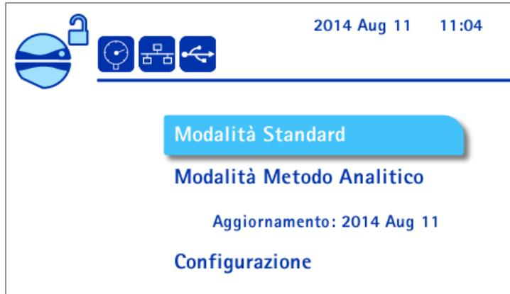
3. Ruotare e premere la manopola di regolazione per selezionare **Configurazione**. Viene visualizzata la schermata del menu **Configurazione**.
