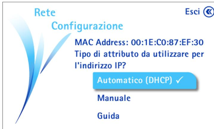
5. Ruotare e premere la manopola di regolazione per selezionare **Manuale**. Sullo schermo vengono visualizzati i parametri di rete.
