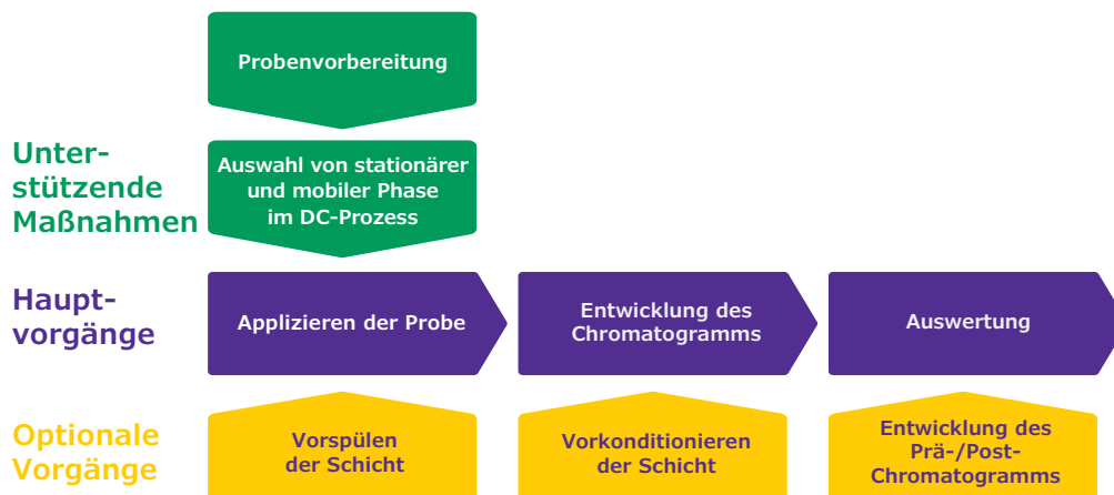
Abbildung 1.2: Prozess der Dünnschichtchromatographie: Vorbereitung der Schicht (Platte), Probenvorbereitung, Auswahl der stationären Phase, Auswahl der mobilen Phase, Probenapplikation, Entwicklung, Derivatisierung, Dokumentation.
