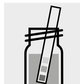
Comprobar el valor del pH de la muestra, valor necesario: pH 6,5. En caso necesario, corregir el valor del pH añadiendo gota a gota solución diluida de hidróxido sódico o de ácido sulfúrico.
