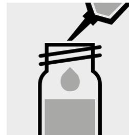
Añadir 1,5 ml de la **muestra preparada** con la pipeta muy lenta, cerrar con la tapa rosca y mezclar **brevemente**. **¡Atención, la cubeta se calienta!**
