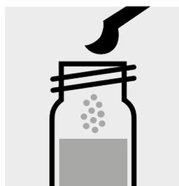
Añadir 1 microcuchara azul rasa de **NO<sub>3</sub>-1K** en un tubo de ensayo. Cerrar **inmediatamente** la cubeta firmemente. **¡Atención, intensa formación de espuma (gafas de protectoras, guantes)!**
