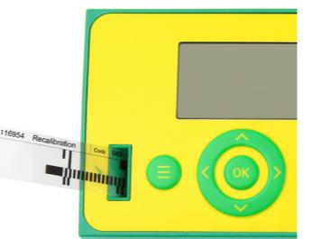
テストストリップアダプターにテストストリップが挿入されていないことを確認し、[OK] を押します。
