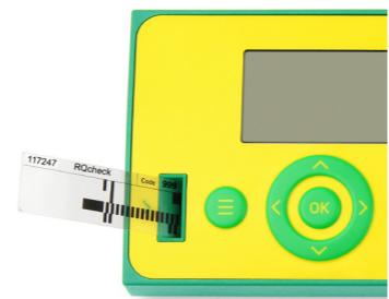
RQcheck用のテストストリップをテストストリップアダプターに挿入し、[測定START] ボタンを押します。
