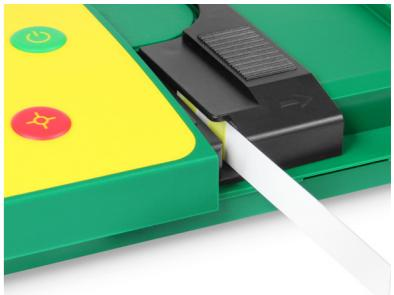
リキャリブレーションセットの補正用ストリップ (RQflex® 20 の同封品に含まれている物) を斜めになっている方を外側に向けて上にし、ストリップアダプターに挿入したら、[測定 START] ボタンを押します。
