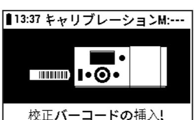
補正用のバーコードストリップ (RQflex® 20 の同封品に含まれている物) をパックから取り出します。
