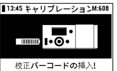
補正用バーコードストリップをパック (RQflex® 20 の同封品に含まれている物) から取り出します。
