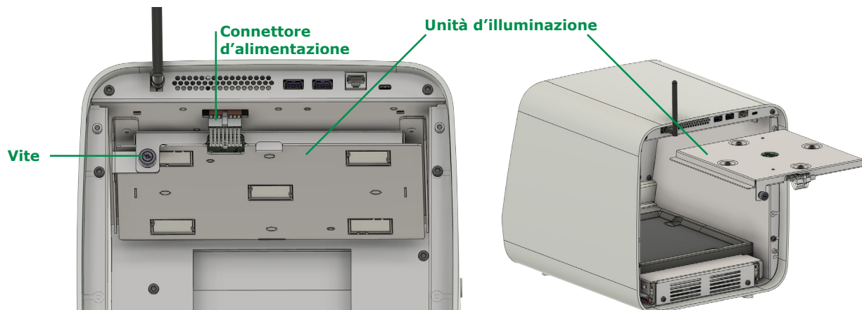
Figura 10.3: Sostituzione dell'unità di illuminazione
