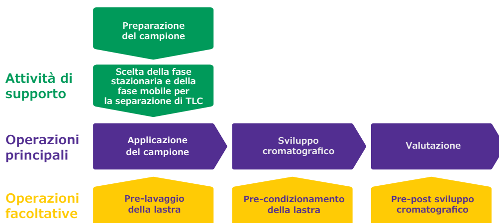
Figura 1.2: Processo della TLC: preparazione dello strato (lastra), preparazione del campione, scelta della fase stazionaria, scelta della fase mobile, applicazione del campione, sviluppo, derivatizzazione, documentazione.
