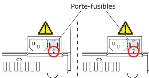
Fonctionnement en 230 V Fonctionnement en 115 V
