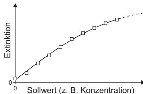
Bild 4-4 Beispiel einer Parabel-Kalibrierfunktion nach 10 Punkte-Kalibrierung
