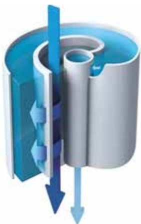
Veduta trasversale di una membrana RO d'avanguardia inserita nella cartuccia. Il flusso tangenziale limita il rischio di intasamento.
