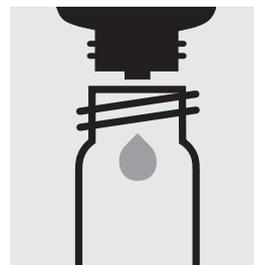
Verser 6 gouttes de **Cl<sub>2</sub>-1** dans un tube de 16 mm.
