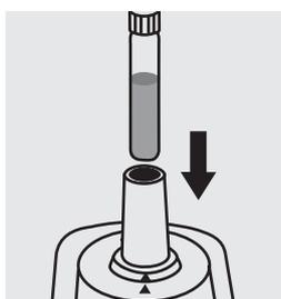
Replacer le tube de l'échantillon dans le compartiment, faire coïncider le trait du tube sur celui du photomètre. Appuyer de nouveau sur **[Zero/Test]**. (= T2)
