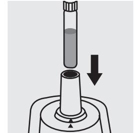
Placer le tube à blanc dans le compartiment. Appuyer sur **[Zero/Test]**.
