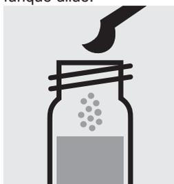
Ajouter 1 microcuiller bleue arasée de O<sub>3</sub>-2, fermer avec le bouchon fileté.
