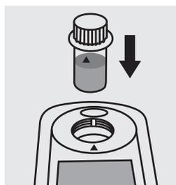
Placer le tube à blanc dans le compartiment, faire coïncider le trait du tube sur celui du photomètre. Appuyer sur **[Zero/Test]**.
