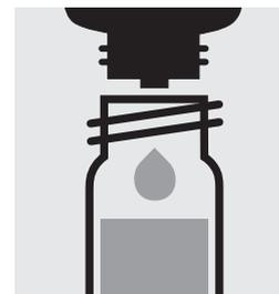
Ajouter 2 gouttes de  **$\text{ClO}_2$ -1**, fermer avec le bouchon fileté et mélanger.
