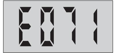
Le réglage de fabrication pour U.2 n'est pas correct / est effacé
