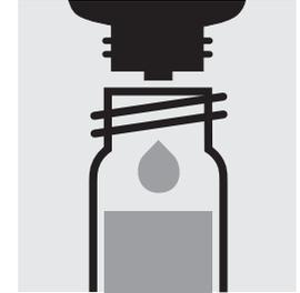
Ajouter 2 gouttes de  **$\text{ClO}_2$ -1**, fermer avec le bouchon fileté et mélanger.
