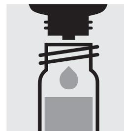
Retirer la tube à échantillon du photomètre, l'ouvrir, ajouter 2 gouttes de **Cl<sub>2</sub>-2**, fermer avec le bouchon fileté et mélanger.
