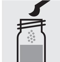
Ajouter 1 microcuiller bleue arasée de  **$\text{ClO}_2$ -2**, fermer avec le bouchon fileté.
