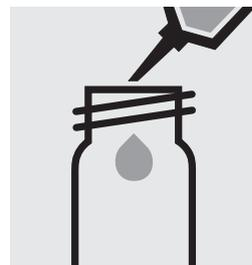
Pipetter 10 ml d'échantillon dans un tube de 16 mm.
