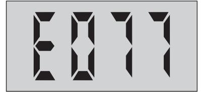
Le réglage de fabrication pour U.9 n'est pas correct / est effacé
