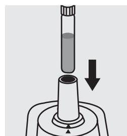
Placer le tube à blanc dans le compartiment. Appuyer sur **[Zero/Test]**.
