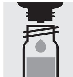
Ajouter 2 gouttes de O<sub>3</sub>-1, fermer avec le bouchon fileté et mélanger.
