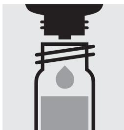
Ajouter 2 gouttes de **Cl<sub>2</sub>-2** dans chacun de deux tubes, fermer avec le bouchon fileté et mélanger.
