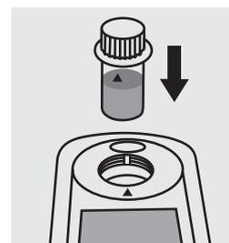
Placer le tube de l'échantillon dans le compartiment, faire coïncider le trait du tube sur celui du photomètre. Appuyer de nouveau sur **[Zero/Test]**.
