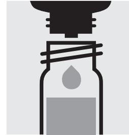
Ajouter 4 gouttes de **pH-1**, fermer avec le bouchon fileté et mélanger. **Attention**, tenir **absolument** le flacon de réactif **verticalement**.
