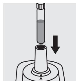
Placer le tube de l'échantillon dans le compartiment. Appuyer de nouveau sur **[Zero/Test]**.
