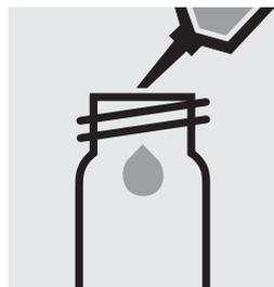
Introduire env. 10 ml d'eau distillée dans un tube de 24 mm (**ne pas ajouter de réactifs**) et fermer avec le bouchon fileté. (Tube à blanc)
