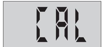
En tenant compte de la tolérance, quand le résultat correspond à la valeur de l'étalon, on quitte le mode de réglage en appuyant sur la touche **[On/Off]**. L'appareil s'éteint. Le réglage n'est pas mémorisé car il ne se distingue pas de réglage de fabrication.
