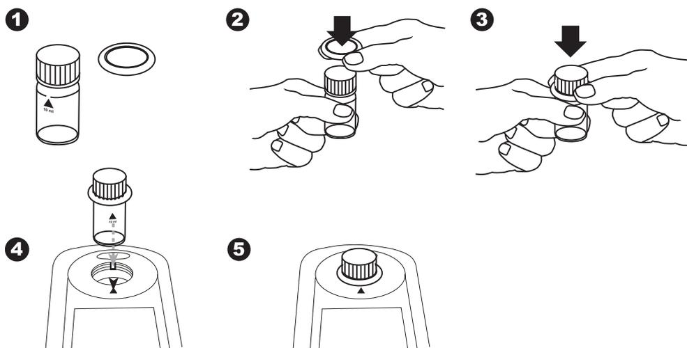
**Faire coïncider le triangle sur le tube avec le marquage triangulaire du Spectroquant® Move.
