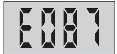
Le réglage de fabrication pour U.10 n'est pas correct / est effacé
