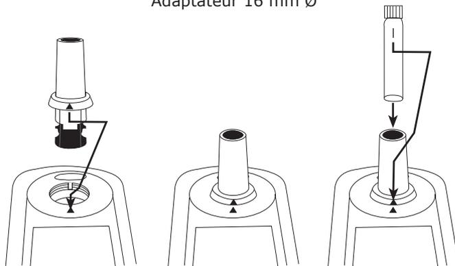
**Faire coïncider le triangle sur l'adaptateur avec le marquage triangulaire du Spectroquant® Move.**
