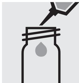
Introduire env. 10 ml d'eau distillée dans un tube de 16 mm (**ne pas ajouter de réactifs**) et fermer avec le bouchon fileté.
