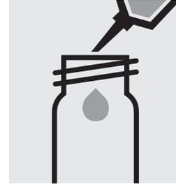
Pipetter 10 ml d'échantillon dans un tube de 24 mm.
