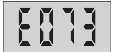
Le réglage de fabrication pour U.3 n'est pas correct / est effacé
