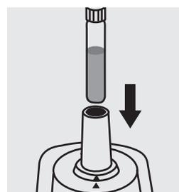
Placer le tube de l'échantillon dans le compartiment. Appuyer de nouveau sur **[Zero/Test]**. (= T1)
