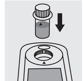
Placer le tube à blanc dans le compartiment, faire coïncider le trait du tube sur celui du photomètre. Appuyer sur **[Zero/Test]**.
