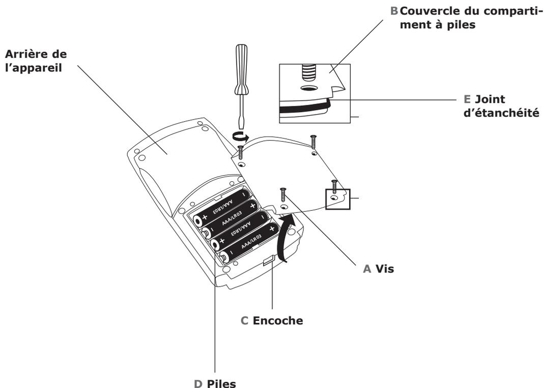
1. Mettre le colorimètre Spectroquant® Move hors tension.
