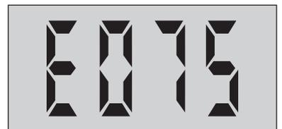
Le réglage de fabrication pour U.4 n'est pas correct / est effacé
