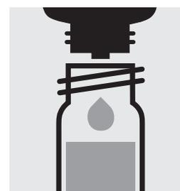
Retirer la tube à échantillon du photomètre, l'ouvrir, ajouter 2 gouttes de **Cl<sub>2</sub>-3**, fermer avec le bouchon fileté et mélanger.
