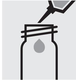
Introduire env. 10 ml d'eau distillée dans un tube de 16 mm (**ne pas ajouter de réactifs**) et fermer avec le bouchon fileté. (Tube à blanc)
