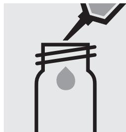
Introduire env. 10 ml d'eau distillée dans un tube de 24 mm (**ne pas ajouter de réactifs**) et fermer avec le bouchon fileté.
