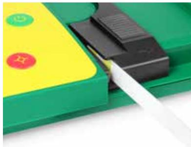
反応時間終了後、自動的に測定が開始します。
