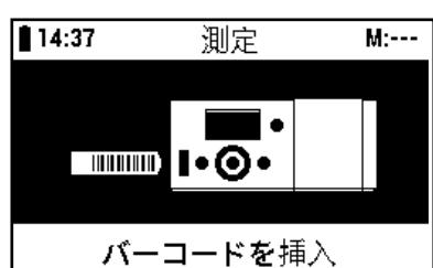
Reflectoquant® パックから専用のバーコードストリップを取り出します。テストによってはバーコードストリップが2枚必要なものもあります。
