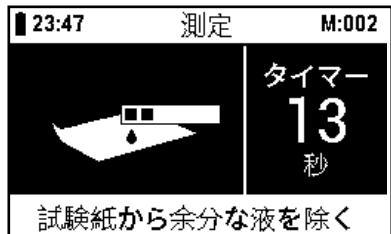
反応時間が終了する前にアラーム音(警告音が0秒より大きな値に設定されている場合、2.6.9の「カウントダウン・アラーム音を設定する」をご参照ください)が鳴ります。これは、ストリップをトリップアダプターに挿入せよという合図です。ストリップは、反応時間終了前に挿入しても構いません。
