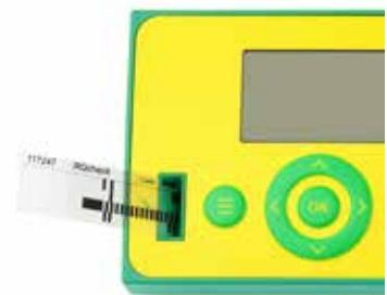
RQcheck用の 試験紙を 試験紙アダプターに挿入し、[測定 START] ボタンを押します。
